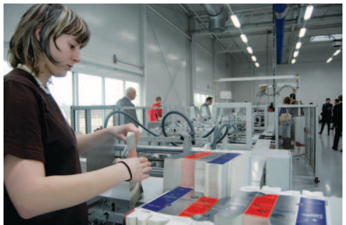
Innovativer Stanzautomat: Ebenfalls gehört eine Bobst-«Vision Cut» für die Verarbeitung von bis zu 4 mm dicker Wellpappe zum Equipment.
