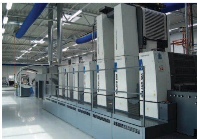
Besonderheit im Drucksaal: «Herzstück» ist eine Manroland-Druckmaschine mit Kaltfolientransfermodul «Inline Foiler Prindor».
