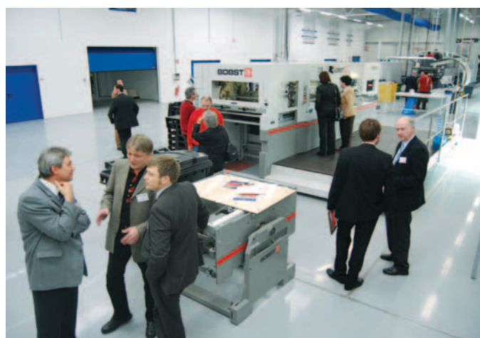
Leistungsfähige Klebmachine: Auch eine Bobst-«Mistral 110» mit Prägemodul «Accu Braille» fand in der neuen Druckerei Platz. (Fotos: Frank Baier)
